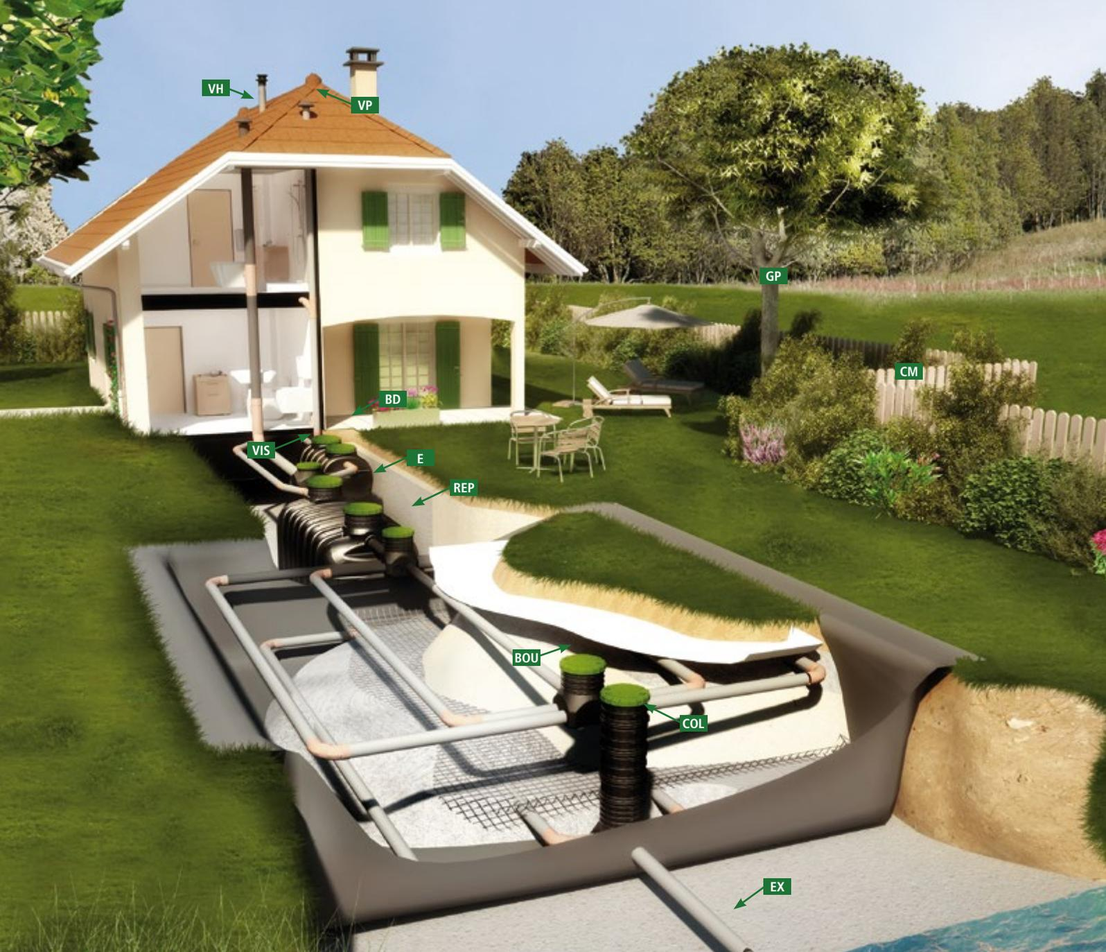
**Filière traditionnelle d'Assainissement Non-Collectif en sol imperméable avec fosse toutes eaux EPURBLOC et filtre à sable vertical drainé livré en Kit FD avec rejet en milieu hydraulique superficiel :**
