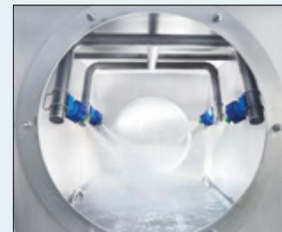
Dispositif de nettoyage en fonctionnement
