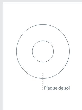
La plaque de sol a été spécialement conçue pour les poteaux à tête arrondie d'un diamètre de 20 cm.
