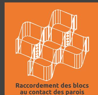
Raccordement des blocs au contact des parois
